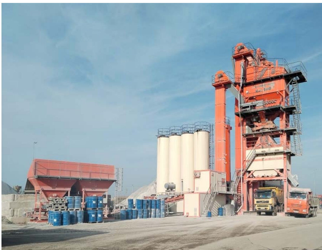
Рис. 6 Асфальтосмесительная установка КА-160-6F
